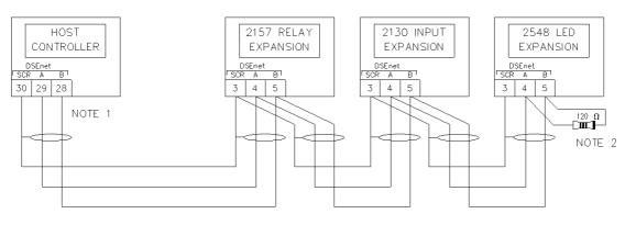
NOTE 1 AS A TERMINATING RESISTOR IS INTERNALLY FITTED TO THE HOST CONTROLLER, THE HOST CONTROLLER MUST BE THE FIRST UNIT ON THE DSEnet NOTE 2 A 120 DHM TERMINATION RESISTOR MUST BE FITTED TO THE LAST UNIT ON THE DSENET
